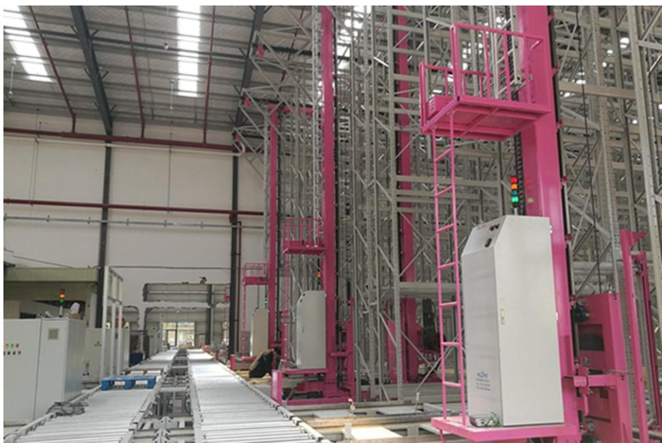
自动化立体仓库的主要优点：（1）仓库作业全部实现机械化和自动化（2）采用高层货架立体储存，能有效地利用空间，减少占地面积，降低土地购置费用。（3）采用托盘或货箱储存货物，货物的破损率大大降低。（4）货位集中，便于控制与管理，特别是使用电子计算机，不但能够实现作业过程的自动控制，而且能够进行信息处理。自动化立体仓库的缺点：（1）结构复杂，配套设备多，需要的基建和设备投资高。（2）货架安装精度要求高，施工比较困难，而且施工周期长。（3）储存货物的品种受到一定限制，对长大笨重货物以及要求特殊保管条件的货物，必须单独设立储存系统。（4）对仓库管理和技术人员要求较高，必须经过专门培训才能胜任。（5）工艺要求高，包括建库前的工艺设计和投产使用中按工艺设计进行作业。（6）弹性较小，难以应付储存高峰的需求。（7）必须注意设备的保管保养并与设备提供商保持长久联系。（8）由于自动化仓库要充分发挥其经济效益，就必须与采购管理系统、配送管理系统、销售管理系统等
